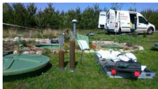
Próba osadowa cieków z reaktora biologicznego oraz badanie poziomu pH
