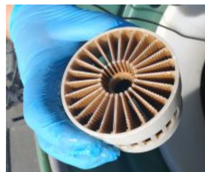
Kształtka fluidalna porożysta z błoną biologiczną
